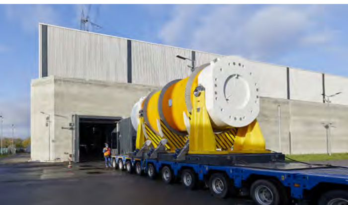
Transporter mit Castorbehälter vor dem Zwischenlager Biblis
