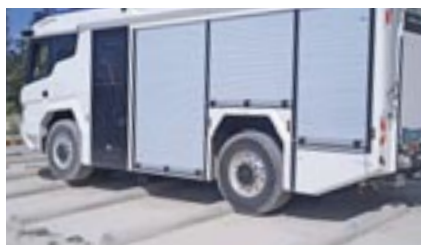
Betonhart: Test der Achsverschränkung auf einer „Buckelpiste“.
