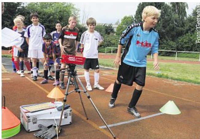
Mit Lichtschranken wurde die Geschwindigkeit gemessen.
