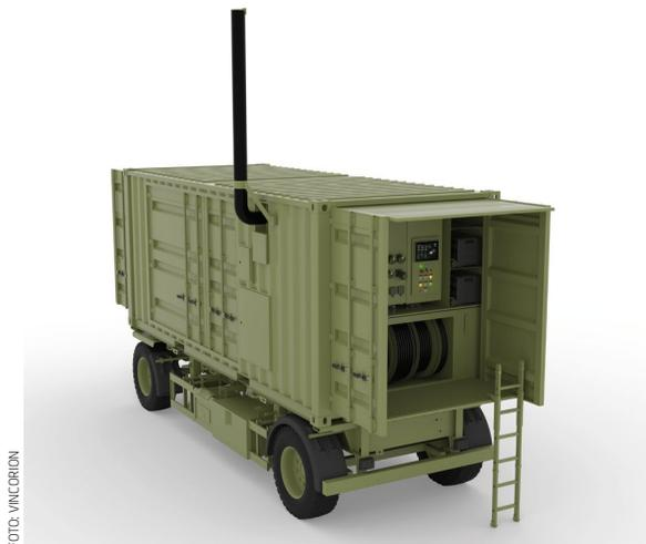
Das Stromerzeugungsaggregat PGM low emissions: Mit diesem Stromerzeuger mit einer Leistung von 20 bis 200 Kilowatt wird Vincorion die Bundeswehr und andere Streitkräfte europäischer Länder ausrüsten.
