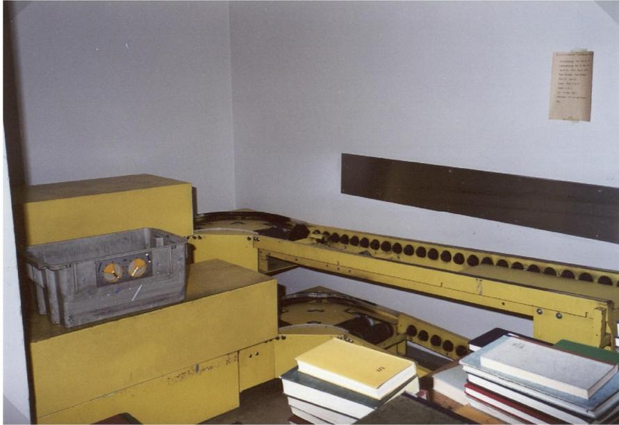
Abb. 50. Mit dem Umlaufzug 3 verbundene Station der Buchkorbförderanlage im 16. Stock des Bücherturms. Versandbahn (oben) und Empfangsbahn (unten) werden umgelenkt und nebeneinander in den Aufzugsschacht eingeführt. Auf der Einladeseite bewegen sich die (pendelnden) Gehänge des Umlaufaufzuges, die Behälter aufnehmen können, in Aufwärtsrichtung und auf der Ausladeseite in Abwärtsrichtung. (Foto vom Juli 2003, Dieter Jonas, SUB)
