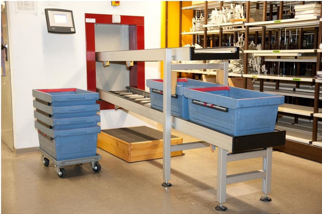
Abb. 76. Eine der drei Stationen der neuen Buchkorbförderanlage im Kompaktmagazin (Foto vom 23.10.2014, Dorothea Ahlers, SUB)
