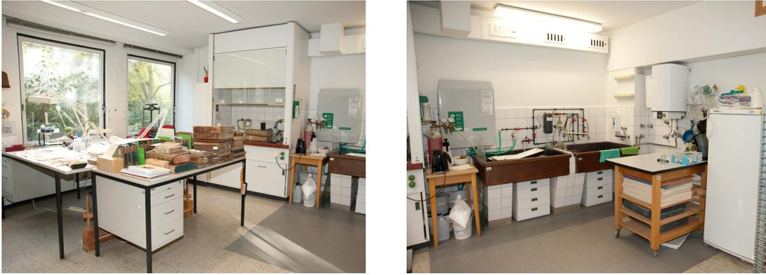
Abb. 38. Restaurierungsstelle in Raum 116 des Verwaltungstrakts mit zwei Arbeitsplätzen an der Fensterfront, dem Abzug (Digestorium) an der Rückwand und daneben den Wässerungsbecken
