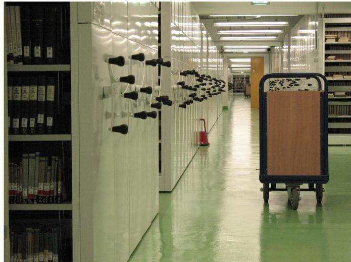
Abb. 81. Fahrregalanlage mit Handantrieb im 1. Untergeschoß des Speichermagazins Bergedorf (Foto vom 10.07.2009, Peter Voigt, SUB)
