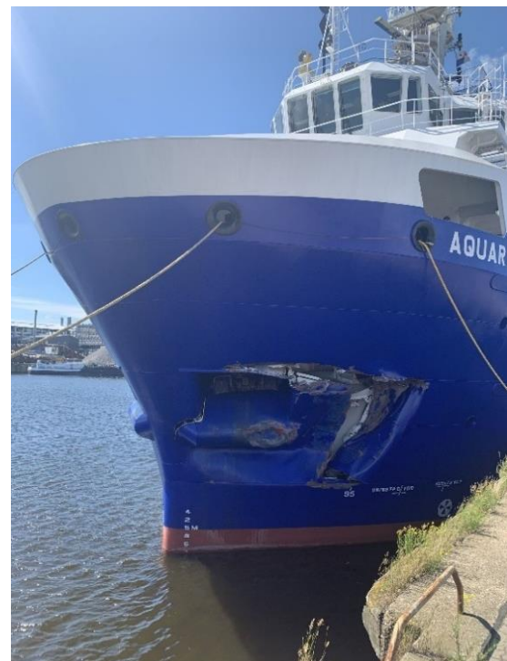
Abbildung 9: Der Bug der AQUARIUS wurde durchstoßen. 23
