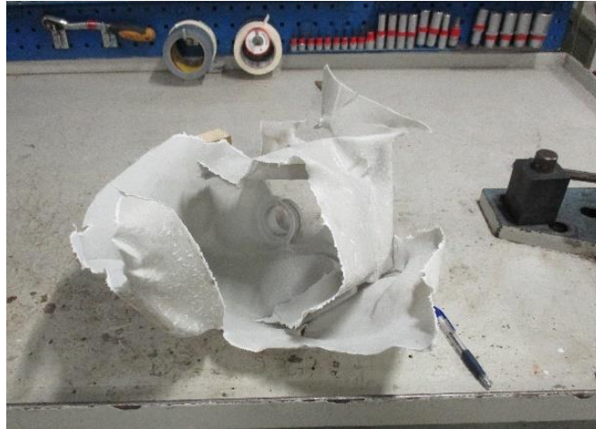
Abbildung 11: Der geborstene Dosier-Behälter 25
