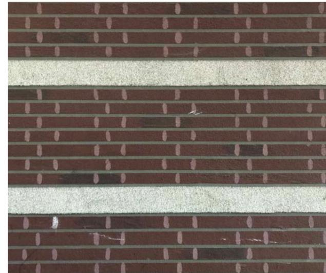
Besandete GFK-beschichtete Styroporplatten
