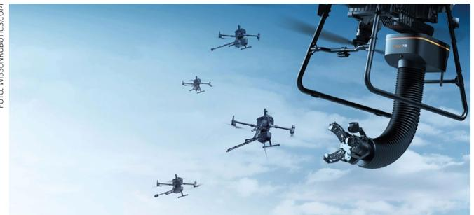
Das kabelgebundene Orion AP3-P3 Pliabot®-Flug-Reinigungssystem reinigt Gebäudefassaden und wartet Türme.
