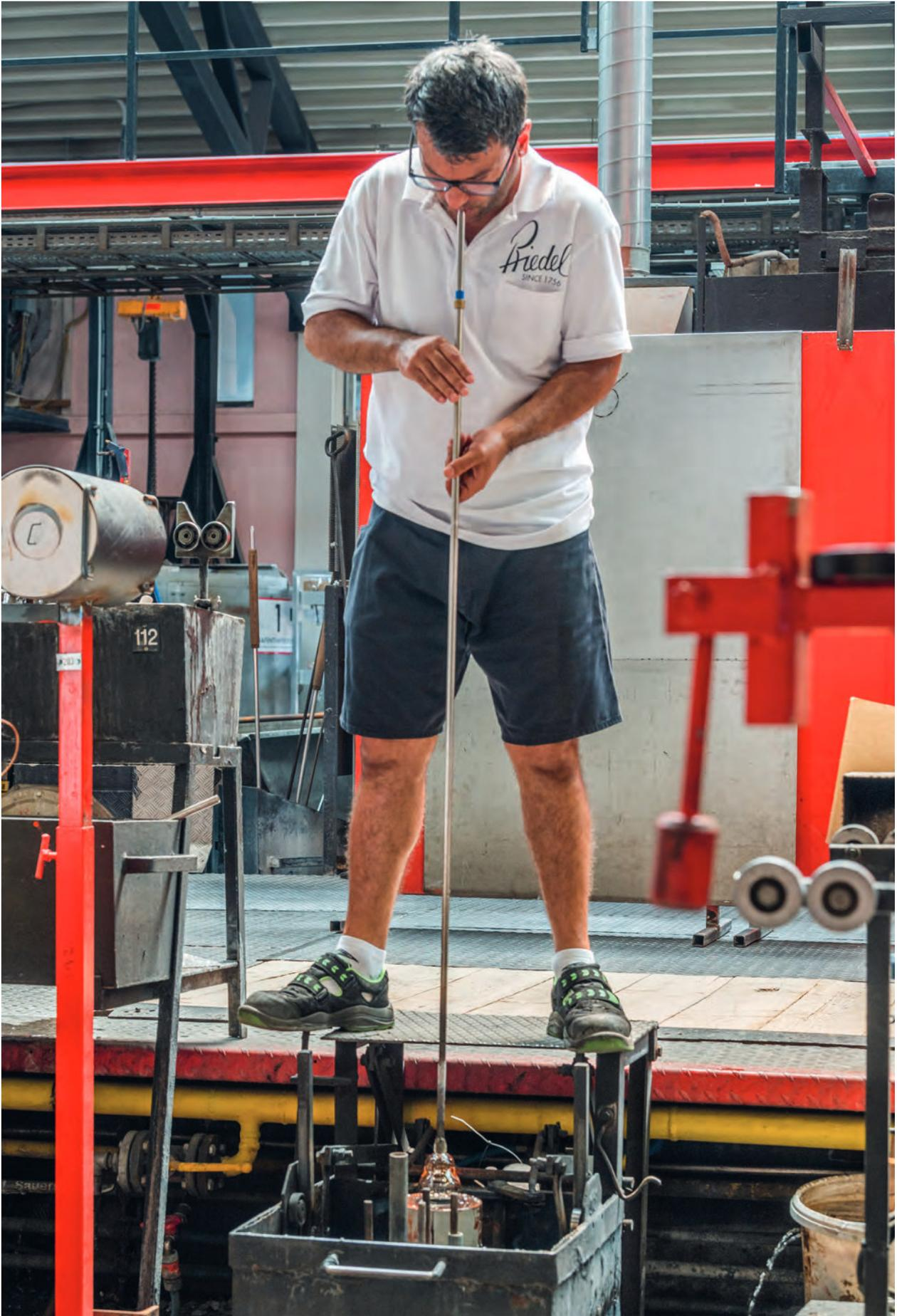
Tropfen heißen Glases, den „Köbel“ eben, mithilfe eines metallischen Blasrohrs, der Glasmacherpfeife, aus dem Ofen entnehmen und dem „Einbläser“ zur Weiterverarbeitung übergeben sollen.
