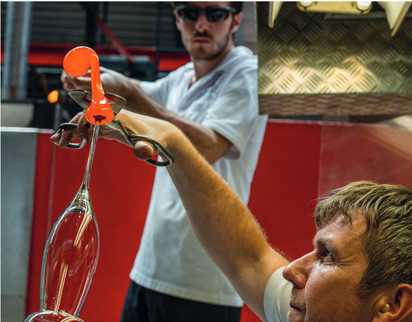
Nachdem der Glasmachermeister mit der Bodenschere einen Tropfen Glas abgeschnitten hat, „klebt“ er ihn an den Stiel und formt anschließend mit einem „Módel“ den Glasboden aus. Dabei kann es sogar passieren, dass das heiße Glas das Holz des „Módel“ in Brand setzt.
