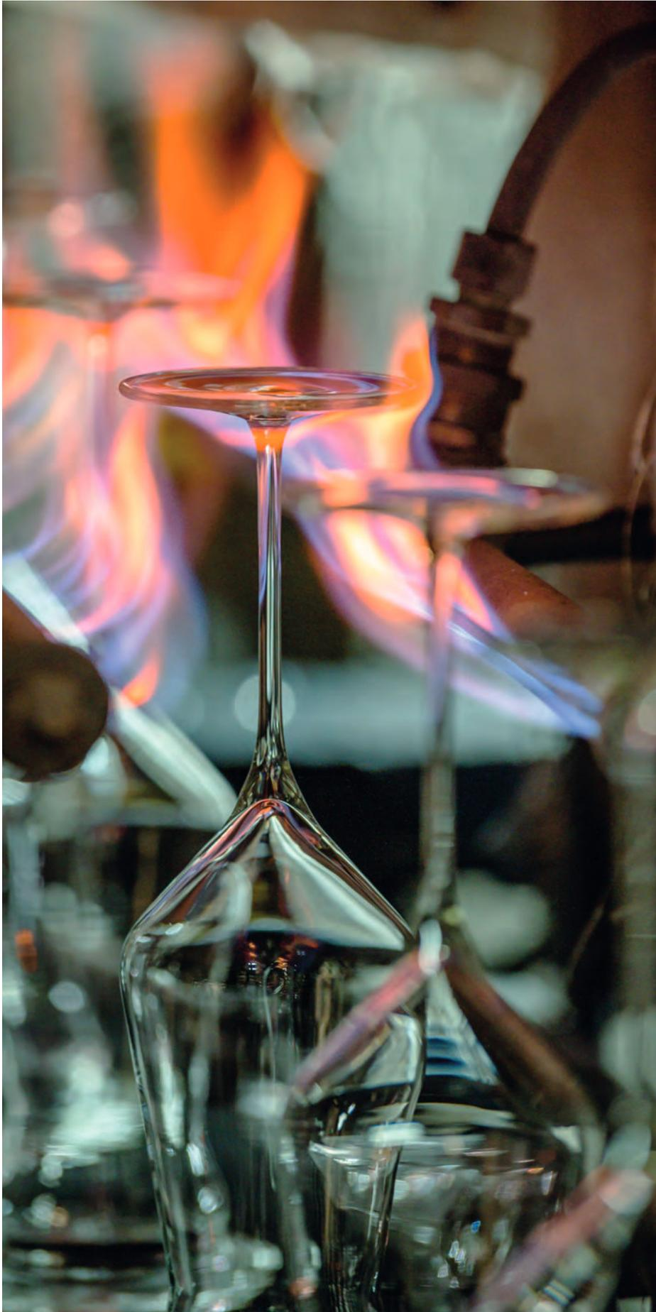
Bis zum letzten Schritt bleibt das Feuer Begleiter des Glases. Erst wenn der Wulst am oberen Rand des Kelches abgetrennt ist, kann dieser geschliffen werden. Der Unterschied zwischen den beiden Burgundergläsern aus maschineller und handwerklicher Fertigung ist auf den ersten Blick nur schwer zu erkennen.
