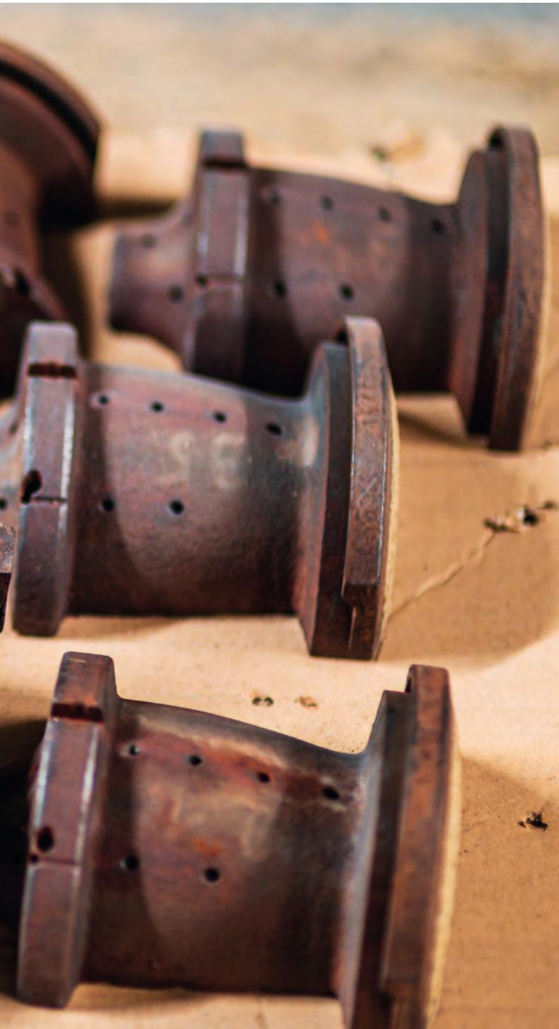
Die Formen, in die der Kelch geblasen wird, bestehen aus zwei Hälften, die sich (u. l.) um den Glastropfen aus der Schmelzwanne schließen. Auf den noch heißen Stumpf (u. m.) wird der Fuß „geklebt“, und dieser Stumpf wird dann in einem dritten Schritt (u. r.) zum schlanken Stiel ausgezogen.
