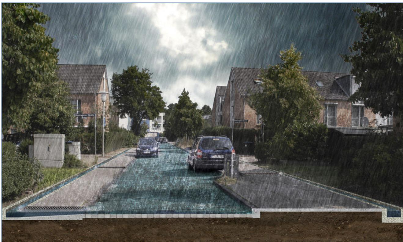
Abb. 71: Beipiellösung B - Entwässerung über offene Rinnen im Seitenraum
