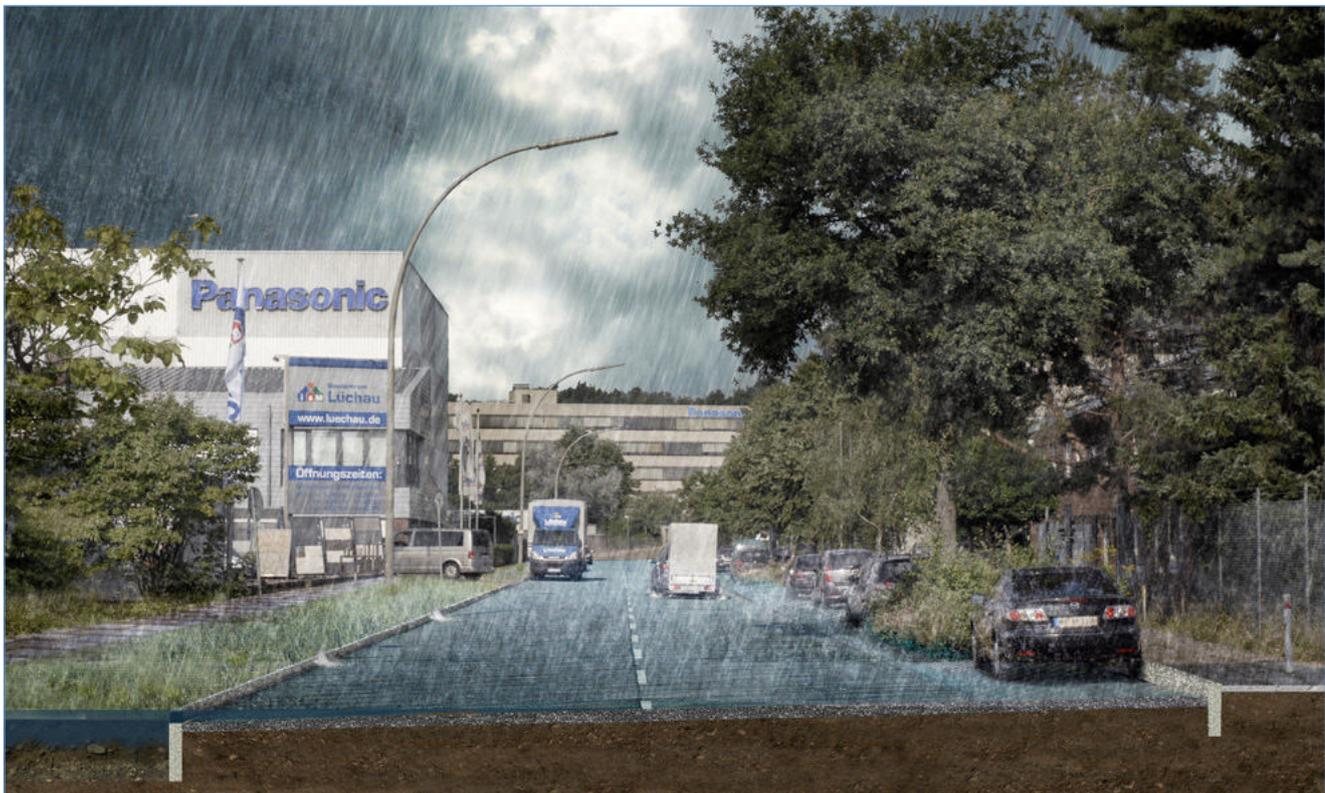
Abb. 57: Beipiellösung B - Breitflächige Versickerung in straßengleitendem Grünstreifen
