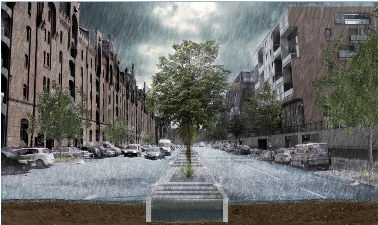
Abb. 43: Beipiellösung B - Entwässerung über speicherfähige Straßenbaumscheiben („treepits“)
