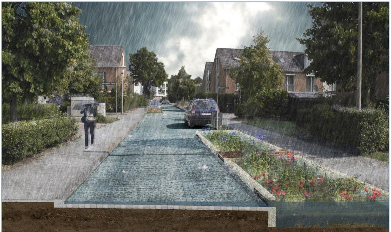
Abb. 69: Beispiellösung A - Entwässerung über Tiefbeete
