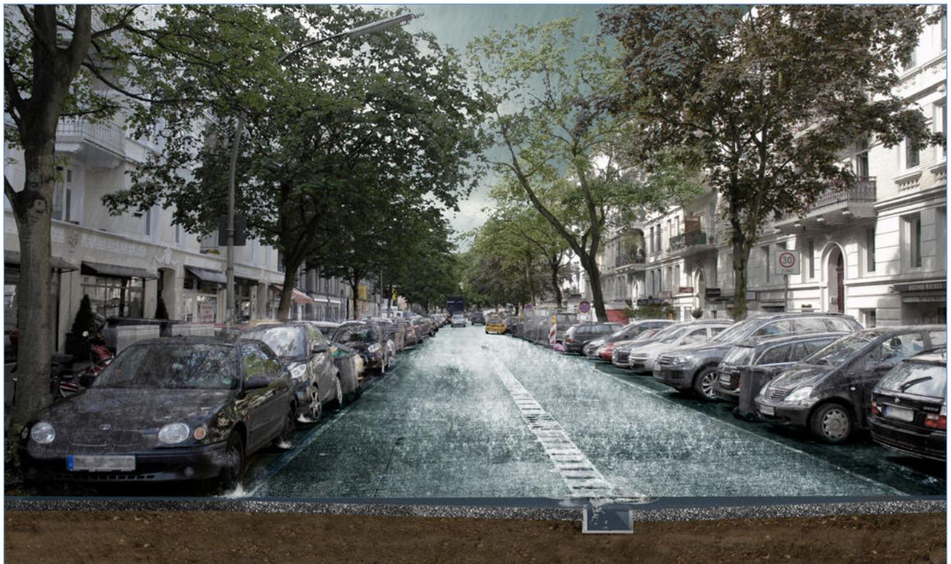
Abb. 50: Beipiellösung B - Anpassung des Straßenprofils (Fahrbahn als Fließgerinne)
