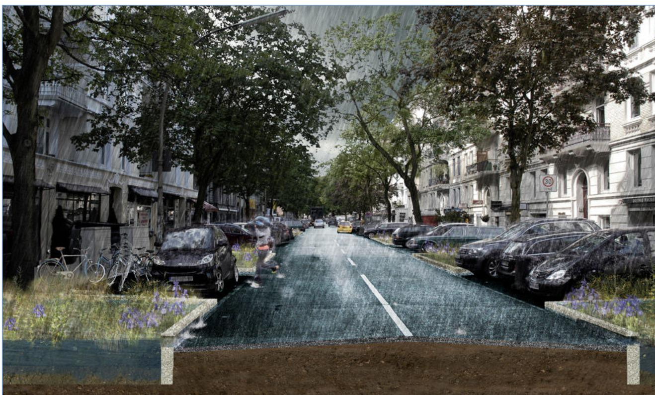
Abb. 48: Beispiellösung A - Entwässerung über Tiefbeete
