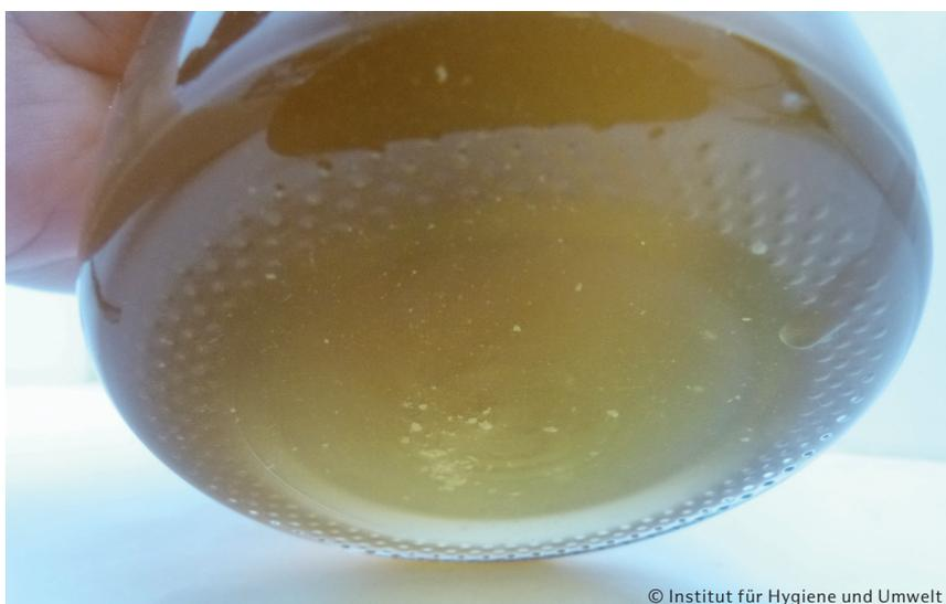
Probe Bier aus Schankanlagen: Trübungen und Partikel in einem normalerweise blanken Pils.
