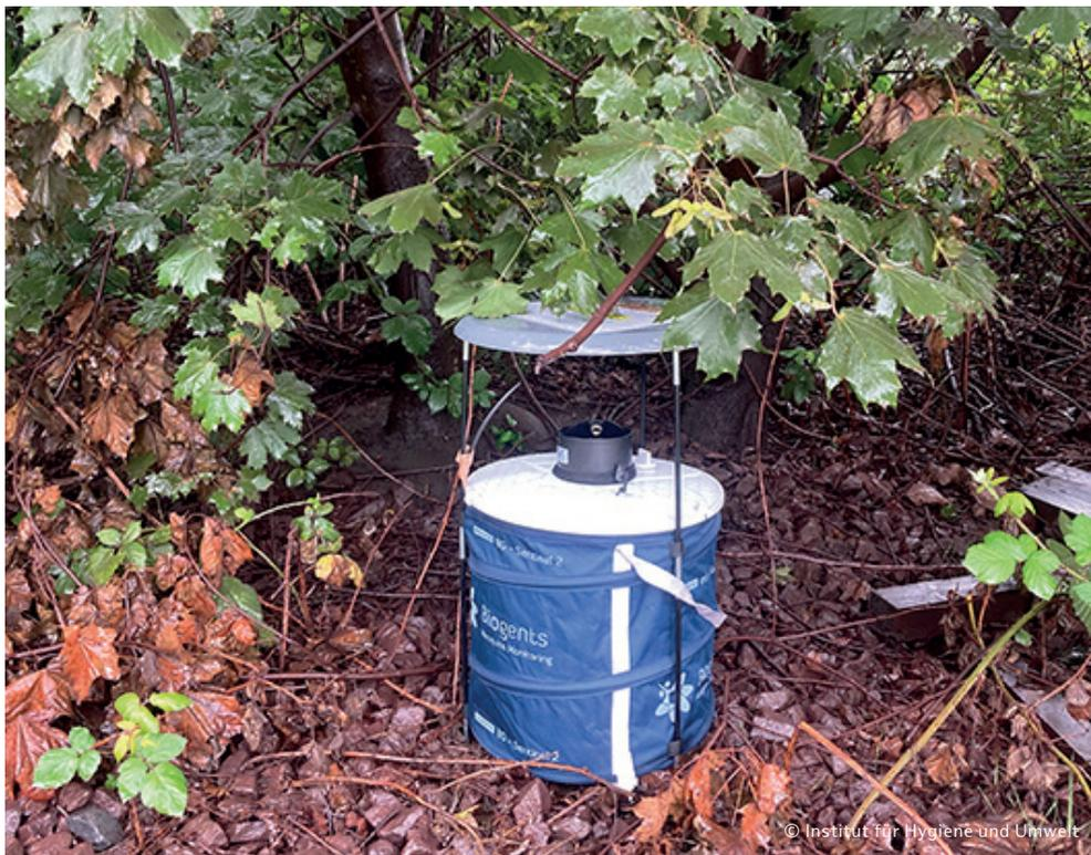
Adulte Stechmücken werden durch Duftstoffe angelockt und mit Hilfe eines Ventilators in die Falle gesaugt.
