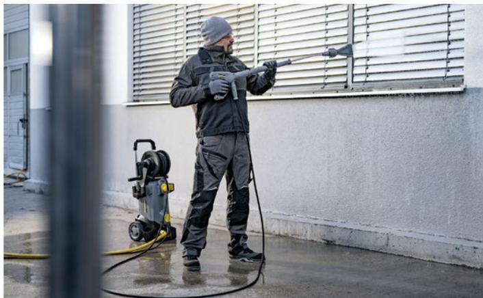
Die Leistungsparameter in der Hochdruckreinigung decken ein weites Feld ab, wobei bei Kaltwassermodellen Drücke von circa 50 bis 500 bar und Fördermengen von 400 l/h bis 12.000 l/h zur Verfügung stehen.
