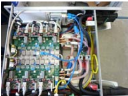
XFEL-Chopper Netzteile 200A/60V
