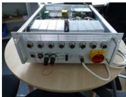
XFEL-Chopper Netzteile 200A/60V
