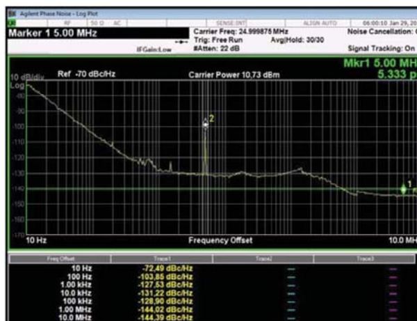
Abbildung 4. Phasenrauschmessung des Master-Taktes mit dem Signalanalysator Agilent PXA N9030A
