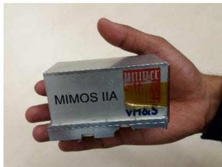
Abb.: 2 MIMOS IIA Mößbauer-Spektrometer
