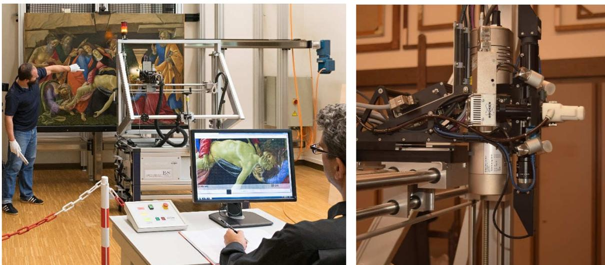
Abb. 1. Links: Gesamtaufnahme des RFA-Scanners während einer der Gemäldeuntersuchung vor der Motorstaffelei, Rechts: Ansicht des Messkopfes mit Kappe (weiß) für Heliumspülung.
