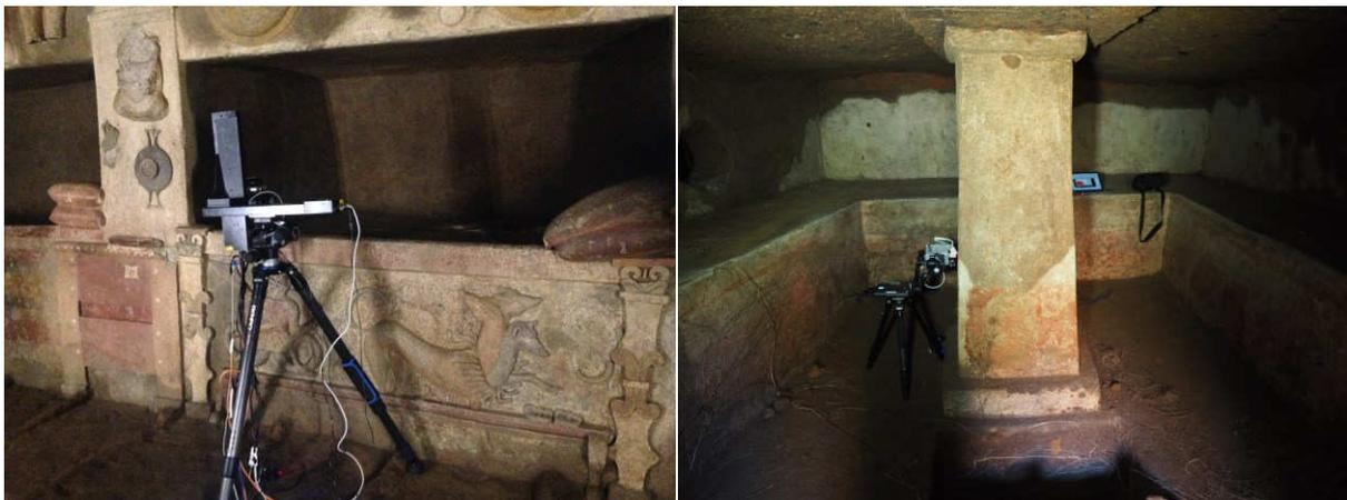
Abbildung 1 Links: Raster RFA Messungen in dem *Grab der Reliefs*. Rechts: RFA Punktmessungen in der *Tomba delle Onde Marine*.
