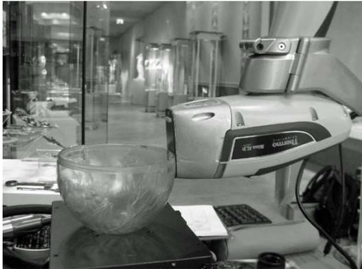
**Abb. 1** Analyse eines gravierten Glases mittels pRFA im LVR-Landesmuseum Bonn, Foto: B.Paz
