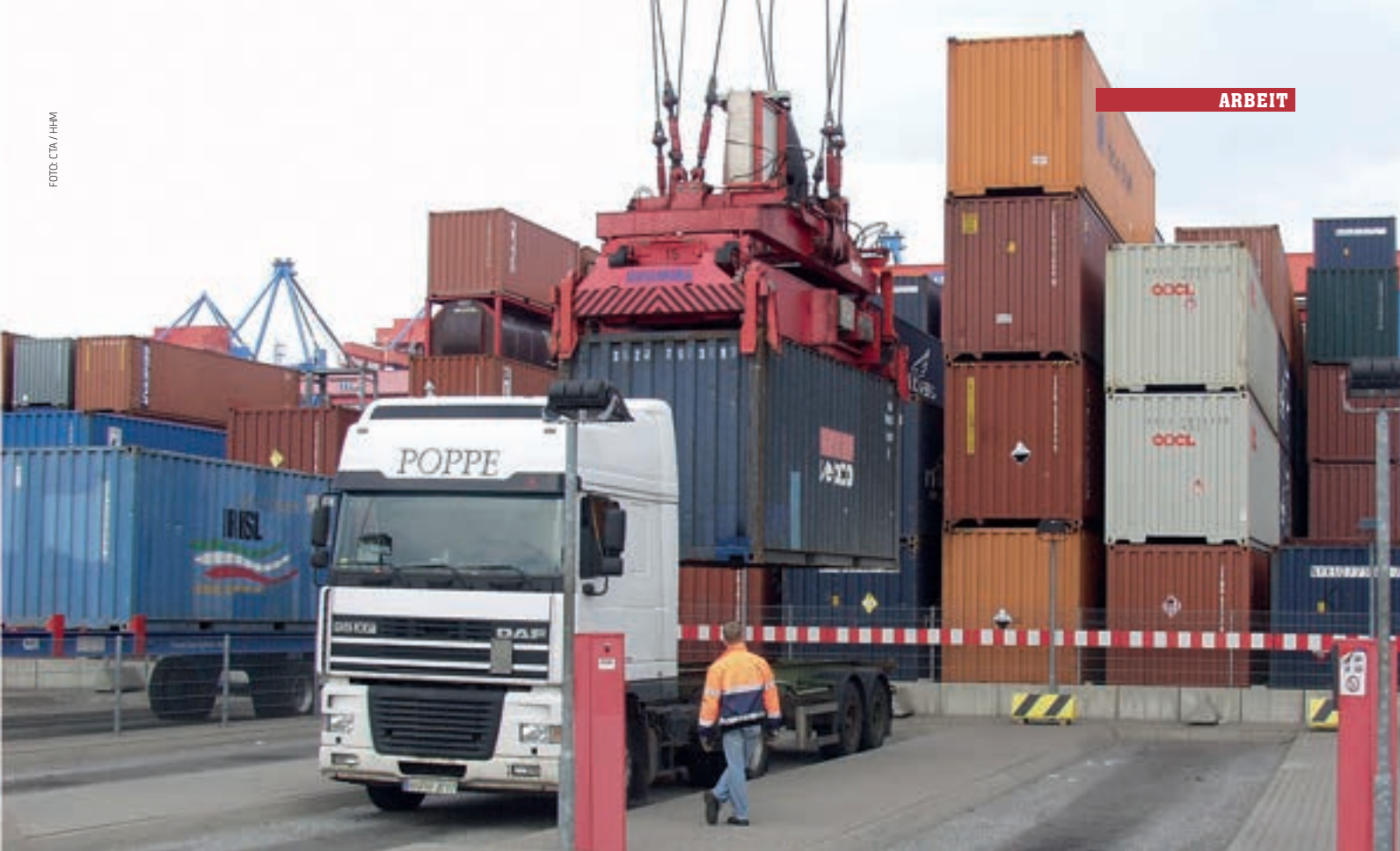
Am HHLA Container Terminal Altenwerder werden die Lkws direkt am automatisierten Container-Blocklager abgefertigt.
