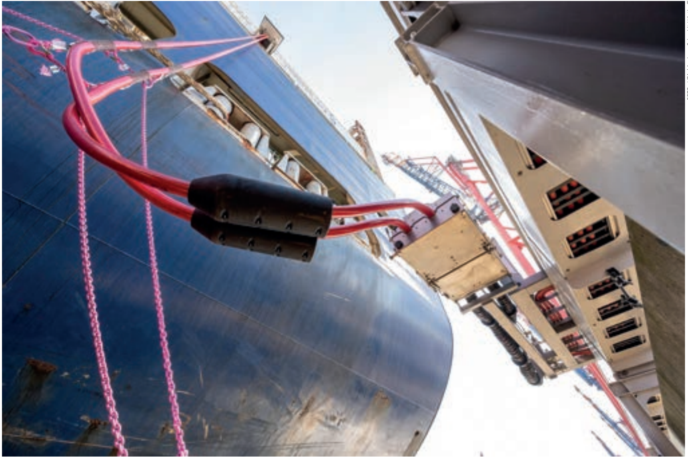
Stromversorgung zwischen Land und Schiff – hier am Eurogate
