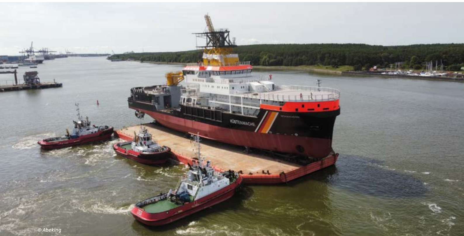
Aufschwimmen: Kasko des neuen Mehrzweckschiffes SCHARHÖRN für die WSV.
