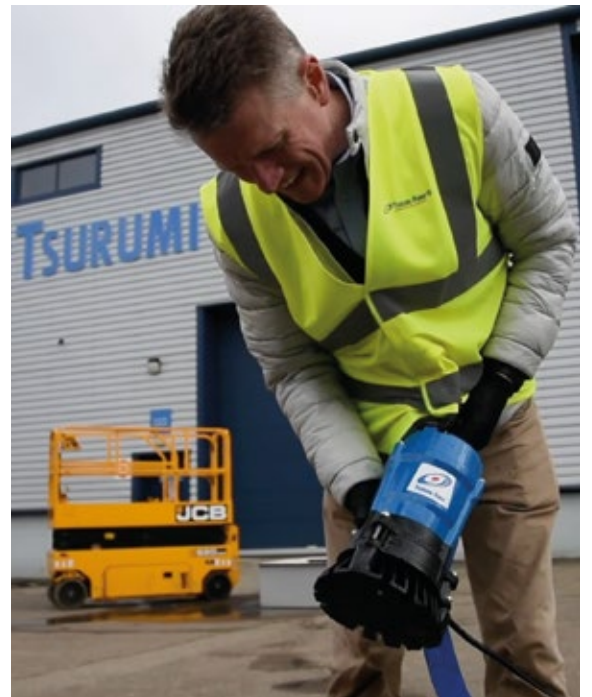
Matthew Hill von Tsurumi zeigt eine HS-Pumpe für Galabauer: Selbst nach dem Sturz aus sieben Metern Höhe lief sie einwandfrei weiter (Foto: Tsurumi)
