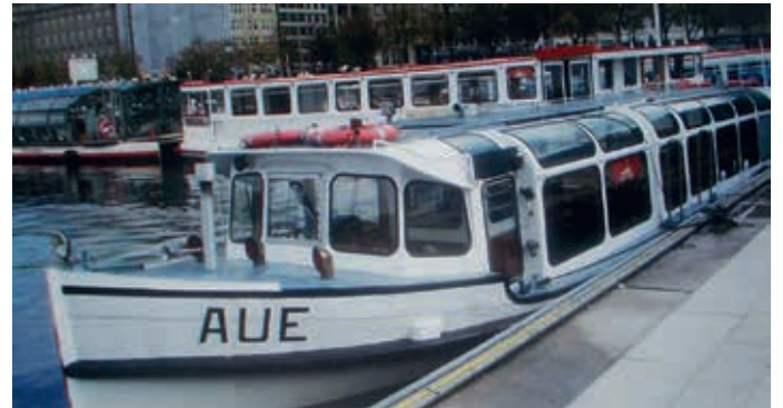
Barkasse „Aue“, 1926 als offene Barkasse „Klaus“ gebaut, die später im Heckbereich einen hölzernen Aufbau und 1960 den jetzigen Aufbau aus Stahl und Glas erhielt. Die „Aue“ ist heute ein Museumsschiff und technisches Denkmal.
