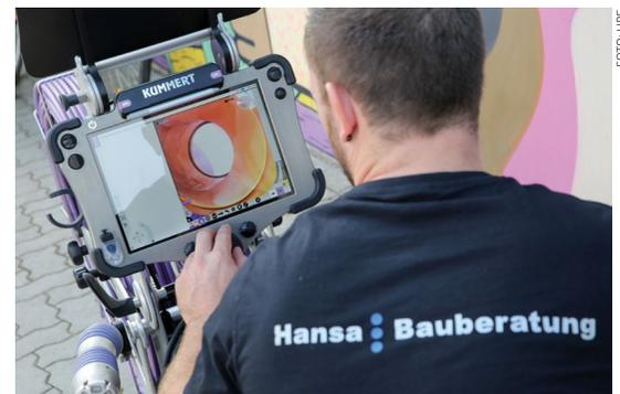
Dichtheitsprüfung mit hochauflösender Kamera.
