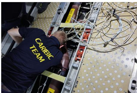
Einbau der Messsonde „Caribic“ bei Lufthansa Technik. Das System verfügt neben der Lufterlassfunktion über Sensoren zur hochfrequenten und -präzisen Messung von Druck und Temperatur.
