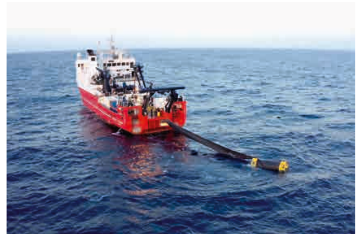
6.5 > Das spanische Forschungsschiff „Sarmiento de Gamboa“ mit einer Wellenpumpe. Sie wurde im November 2022 zu Test- und Forschungszwecken in einem Meeresgebiet südlich Gran Canarias ausgelegt. Der dunkle Auftriebsschlauch ist dabei zunächst um den gelben Schwimmkörper gewickelt und entrollt sich erst, wenn das Bodengewicht in die Tiefe sinkt.
