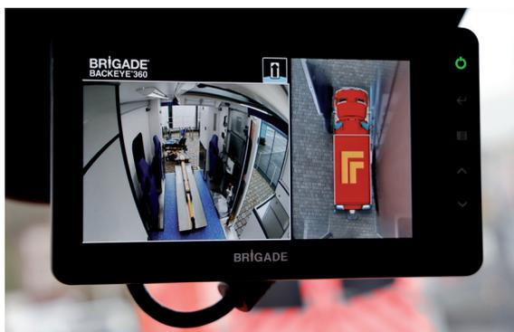
**Erhöhte Sicherheit:** Die 360-Grad-Kamera ermöglicht die Überwachung des Patientenraums sowie der Umgebung
