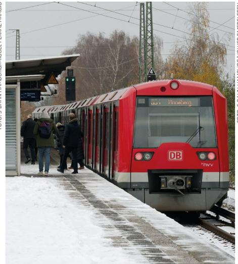
Ältere S-Bahn des Typs ET 474
