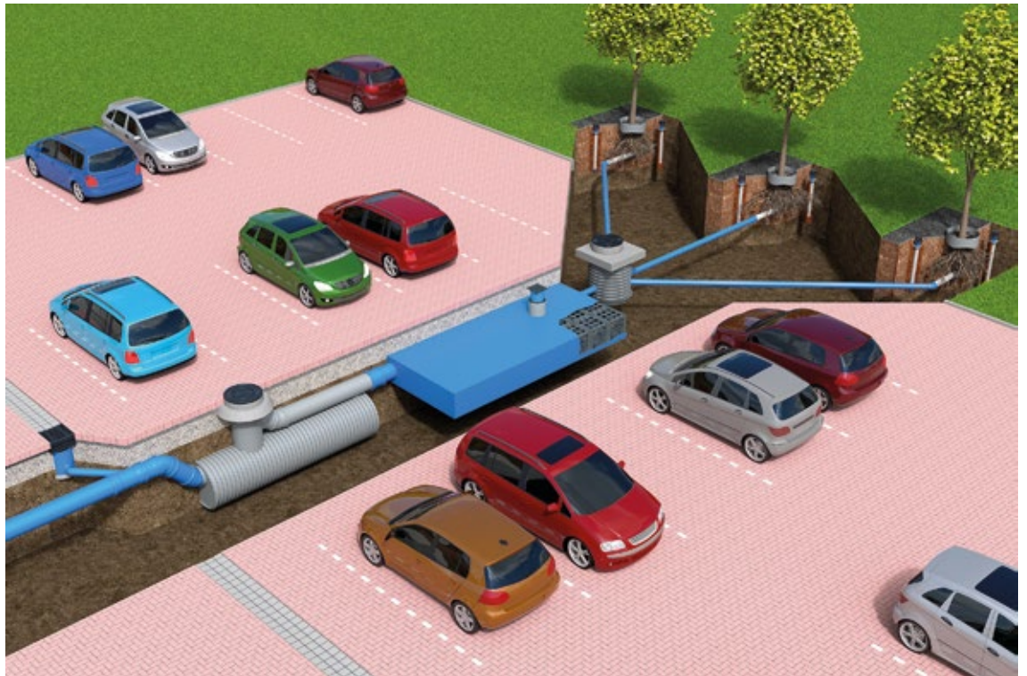
Behandeln, speichern, Bäume bewässern: Die Kombination von Funke Sedimentationsanlage, KS-Bluebox®, D-Raintank 3000®, Funke Drosselschacht und HS®-Vollsickerrohren sorgt für eine optimale Versorgung von Baumstandorten in der Nähe von Verkehrsflächen. (Foto: Funke Kunststoffe)
