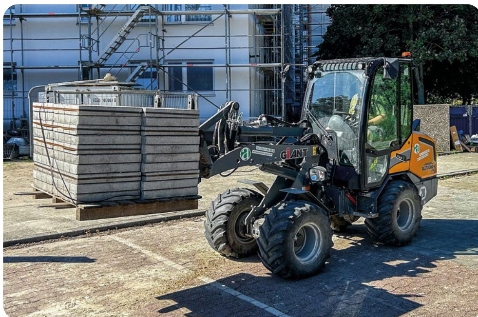
Der GIANT G2700 in der X-TRA HD+ Ausführung sorgt für maximale Hubkraft bei sehr geringem Eigengewicht: So ist das Heben einer kompletten Steinpalette kein Problem. (Foto: TOBROCO-GIANT)
