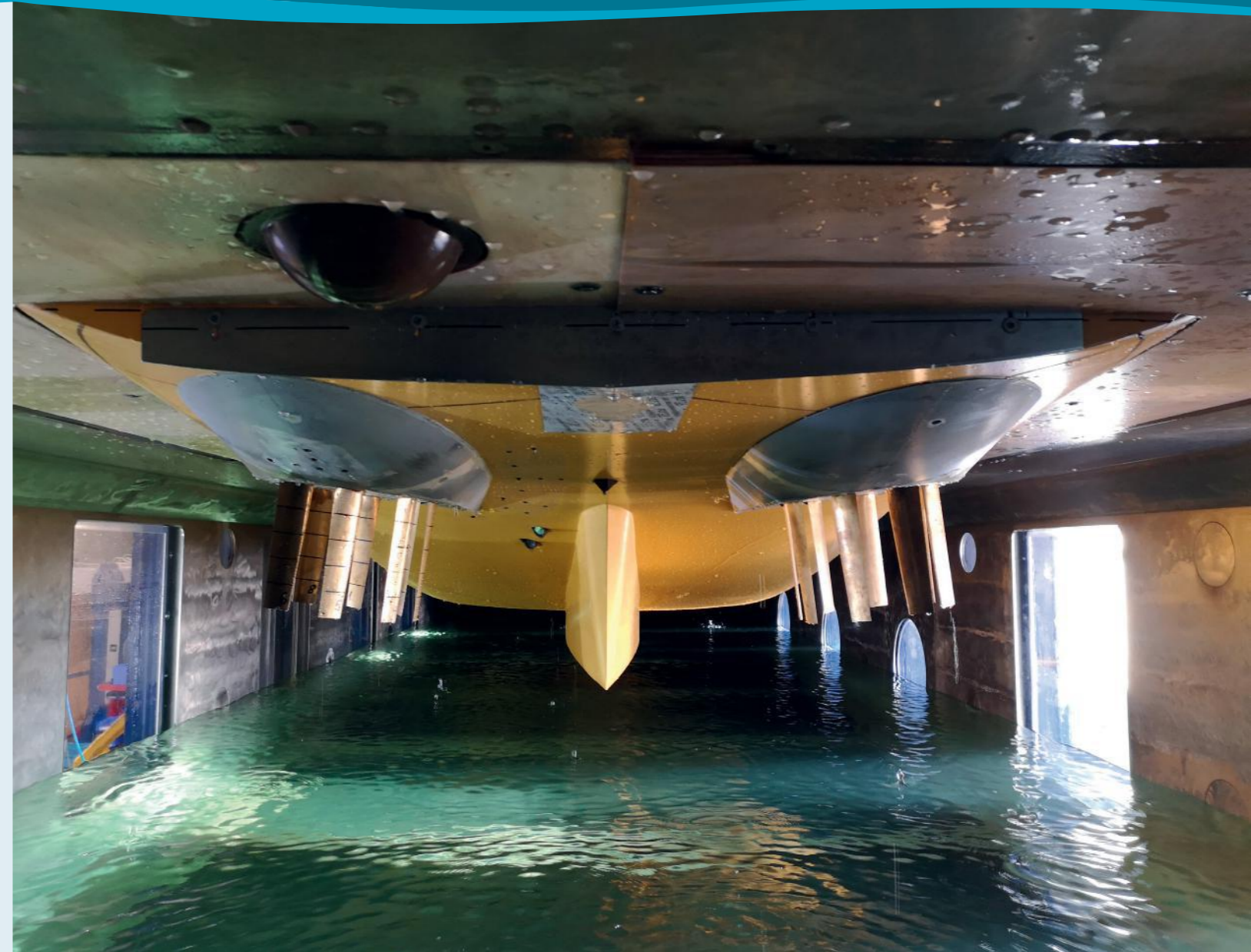
Figure 2: VSP Model with two VSP units in HYKAT (by courtesy of Fr. Fassmer GmbH & Co. KG, J.M. Voith SE & Co. KG, Meyer Fassmer Spezialschiffbau and Bundesministerium für Wirtschaft und Klimaschutz)
