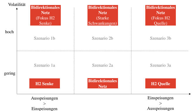
ABBILDUNG 5: EINORDNUNG DER FLEXIBILISIERUNGSBEDARFE IM WASSERSTOFFVERTEILNETZ
