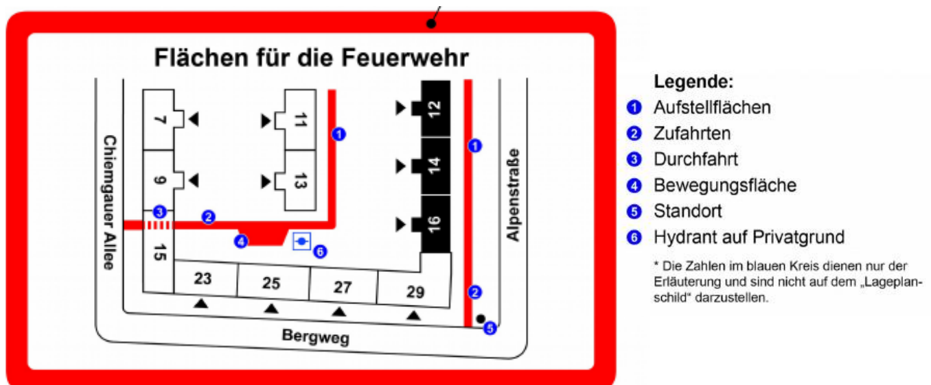
Abbildung 1: Beispiel für ein Lageplanschild nach DIN 4066
