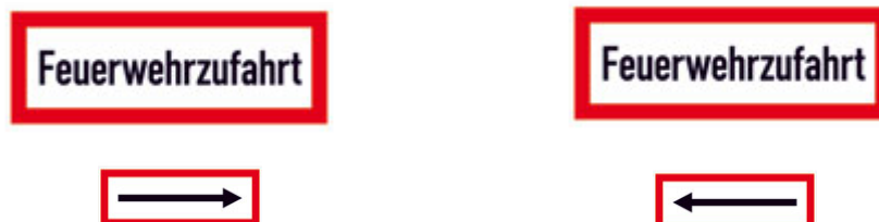
Abbildung 2: Feuerwehrzufahrtsschilder mit Pfeilen, die den freizuhaltenden Bereich eindeutig kennzeichnen
