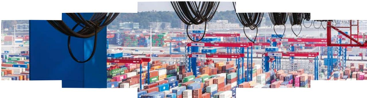
Das Blocklager des HHLA Container Terminal Burchardkai bietet Platz für 39.000 Standardcontainer. Die Flächeneffizienz des Terminals stieg durch die automatisierte Containerlagerung um mehr als 30 Prozent. Das ist im Hamburger Hafen, wo der Raum knapp und jeder Quadratmeter kostbar ist, besonders wichtig.
