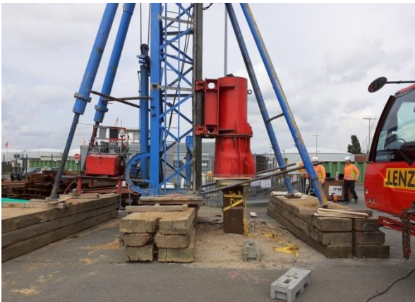
Abb. 11: Probelastungen an lotrechten Ankerpfählen im 1.BA (links dynamische Probelastung, rechts statische Probelastungen)
