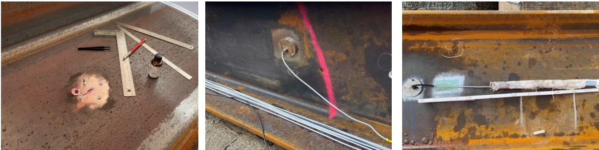
Abb. 24: Applikation der gegenüberliegenden Dehnungsmessstreifen mit wasserdichten Deckeln
