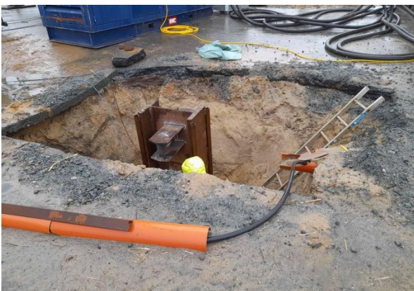
Abb. 12: Dynamische Wiederholungsprüfung an lotrechten Ankerpfählen im 1. BA
