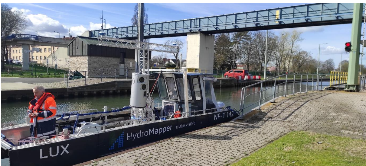
Abb. 16: Einsatz Messboot „LUX“ beim HydroScanning mit Photogrammetriesystem HD Scanning
