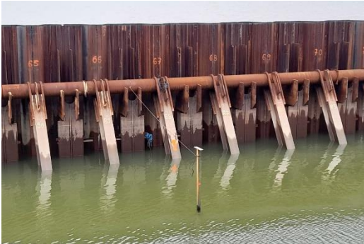
Abb. 14: Setzungsmessung mittels Setzungspegel im 1.BA (links Setzungspegel, rechts gemessenen Setzungen)
