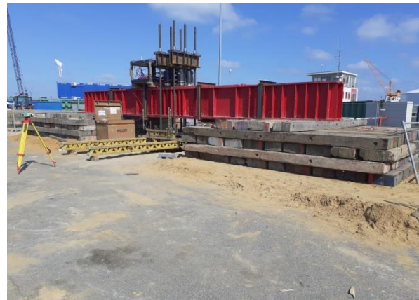
Abb. 11: Probelastungen an lotrechten Ankerpfählen im 1.BA (links dynamische Probelastung, rechts statische Probelastungen)
