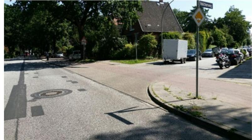
Bei den Negativ-Beispielen suggerieren der in der Einmündung mangelnde Kontrast zwischen Hauptfahrbahn und Rampe sowie die in die Gehwegüberfahrt laufenden Borde eine Vorfahrtregelung Rechts vor Links. Dies ist vor allem bei schlechter Witterung und Dunkelheit der Fall.
