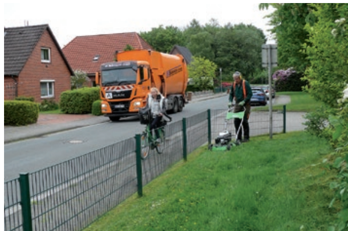
Mähen mit handgeführtem Sichelmäher: Gefahrenbereich durch Herausschleudern von Fremdkörpern, die sich auf der Mähfläche befinden. Auch hier ist ein Freihalten des Gefahrenbereiches unabdingbar sowie ein vorheriges Entfernen von Fremdkörpern von der zu mähenden Fläche.
