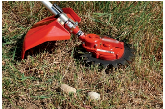
Alternative zu Fadenkopf und Grasschneideblättern: Bei diesem Arbeitswerkzeug arbeiten zwei gegenläufig rotierende Messerblätter. Bei sauberer, präziser und hoher Mähleistung werden weder der Bediener, weitere Personen noch die Umgebung durch weggeschleudertes Schnittgut oder Fremdkörper gefährdet. Der Gefahrenbereich beschränkt sich auf den Schwenkbereich des Freischneiders.
