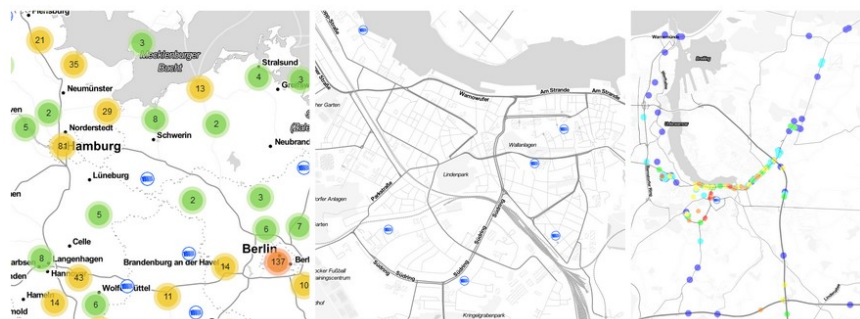
Abbildung 3: Standorte der im TTN-Netzwerk registrierten LoRaWAN Gateways in Norddeutschland und Rostock (linke Seite) sowie eine Heatmap der Signalstärken eines einzelnen Gateways im Stadtzentrum von Rostock (rechte Seite); Quelle: https://ttnmapper.org/heatmap/
