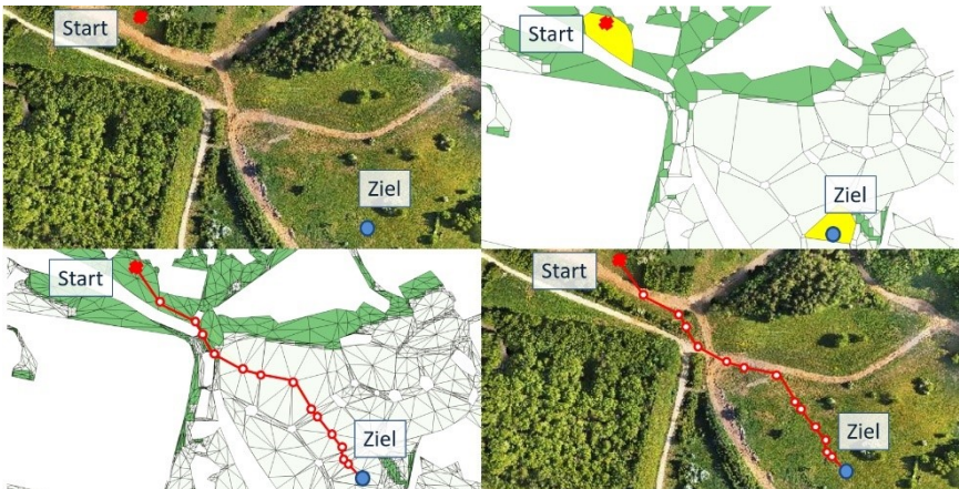
Abbildung 3: Auswertung des routingfähigen Graphen
