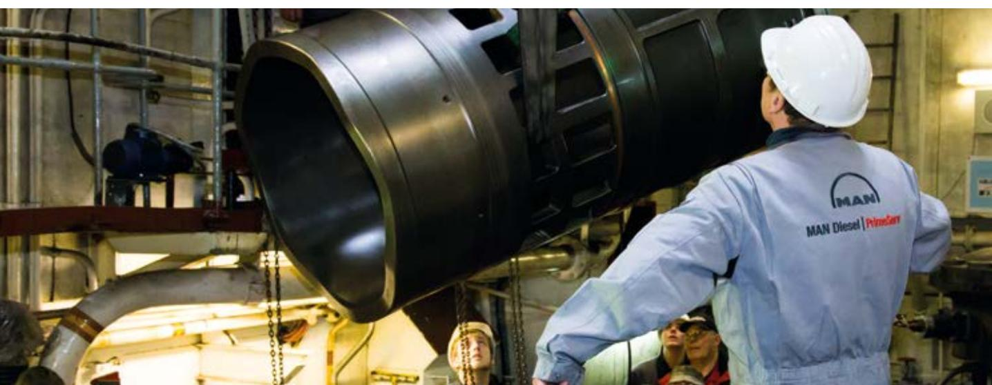
Einbau der neuen Zylinderlaufbuchsen für die CAP SAN DIEGO
