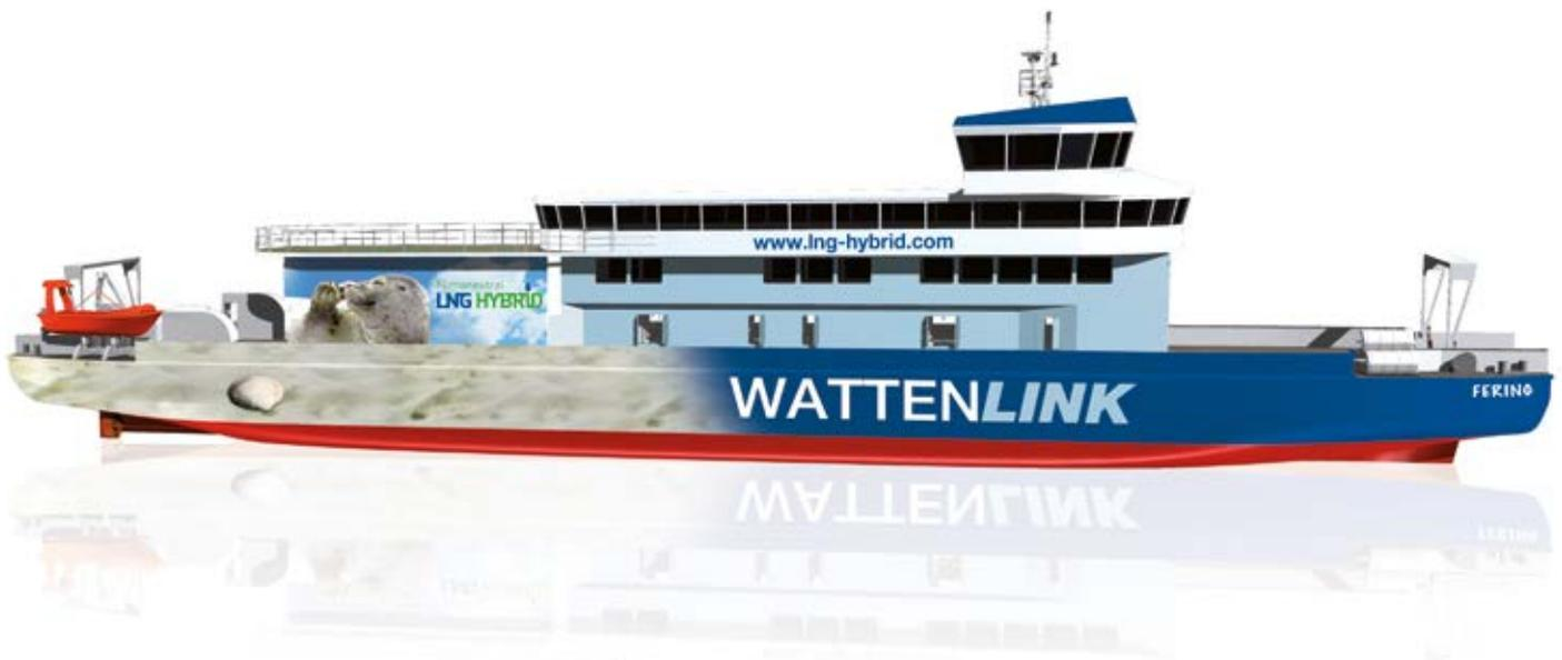
Projekt: Emissionsfreie Wattenfähre mit LNG HYBRID-Antrieb
