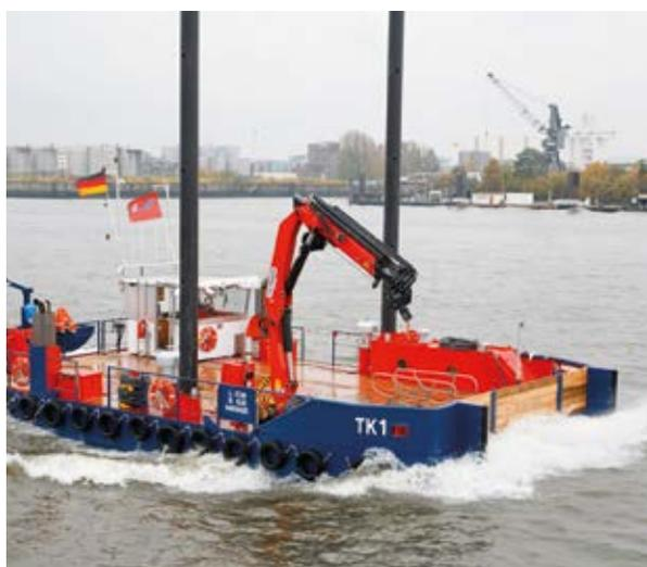
Für den Transport zum Einsatzort zerlegbares Arbeitsschiff TK1
