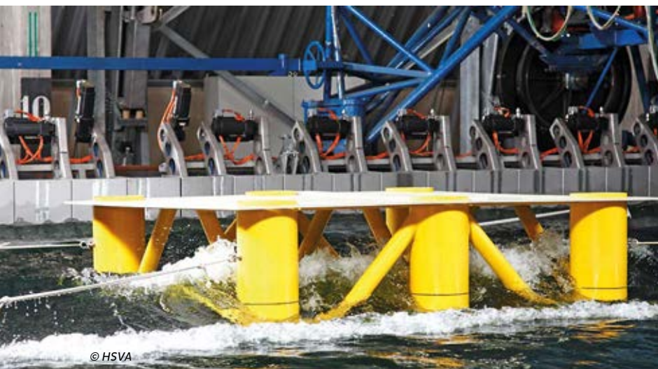
Offshore: Modell einer Plattform in rauer See, die durch den Seitenwellengenerator im großen Schlepptank erzeugt wird
