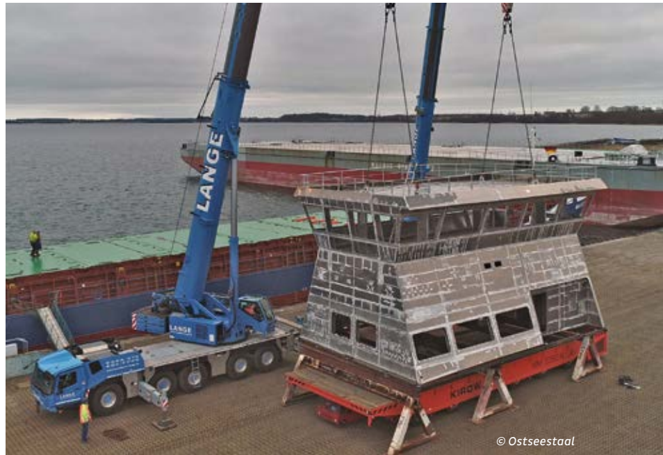
Doppelendfähre: Verladung des Deckshauses in Stralsund
