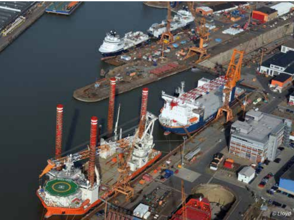
Endausrüstung des Offshore-Errichterschiffes AEOLUS, 87 m
