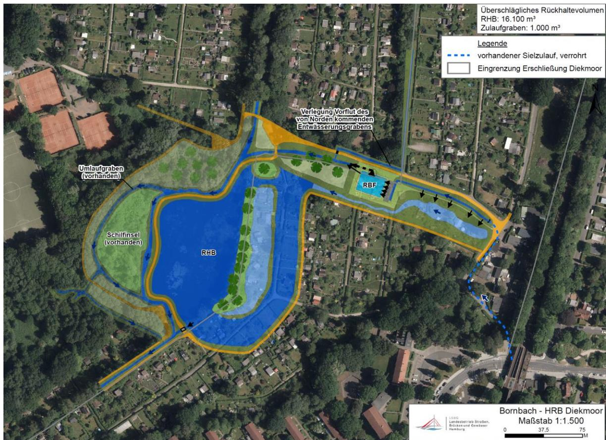
Abb. 36: Übersicht über das Konzept für Retention (HRB) und Reinigung (RBF) am Standort D
