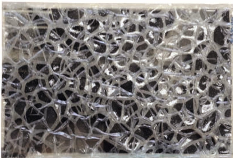
Auflicht-Aufnahme eines degradierten Planfilmnegativs aus Azetatcellulose
