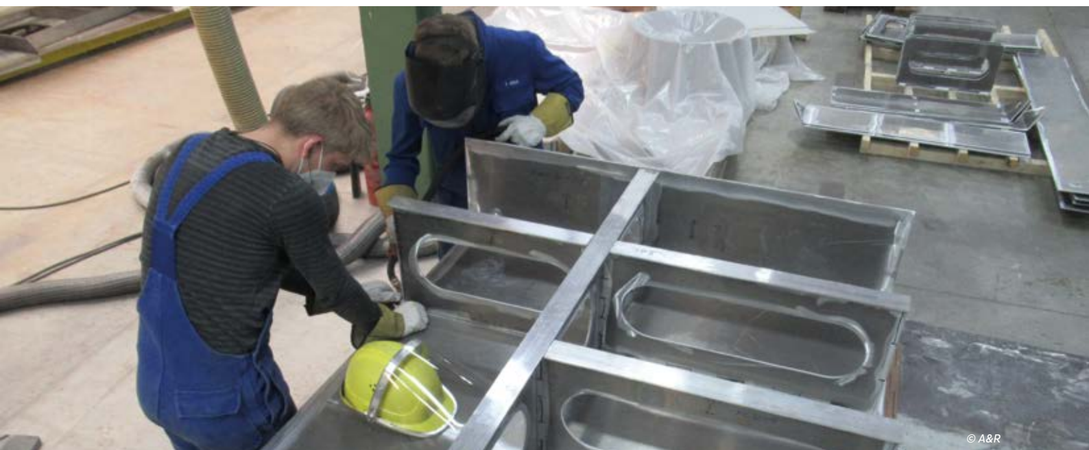
Teamwork: Die Auszubildenden haben den Prototyp einer Sammelplattform für Kunststoffabfälle komplett zusammengebaut
