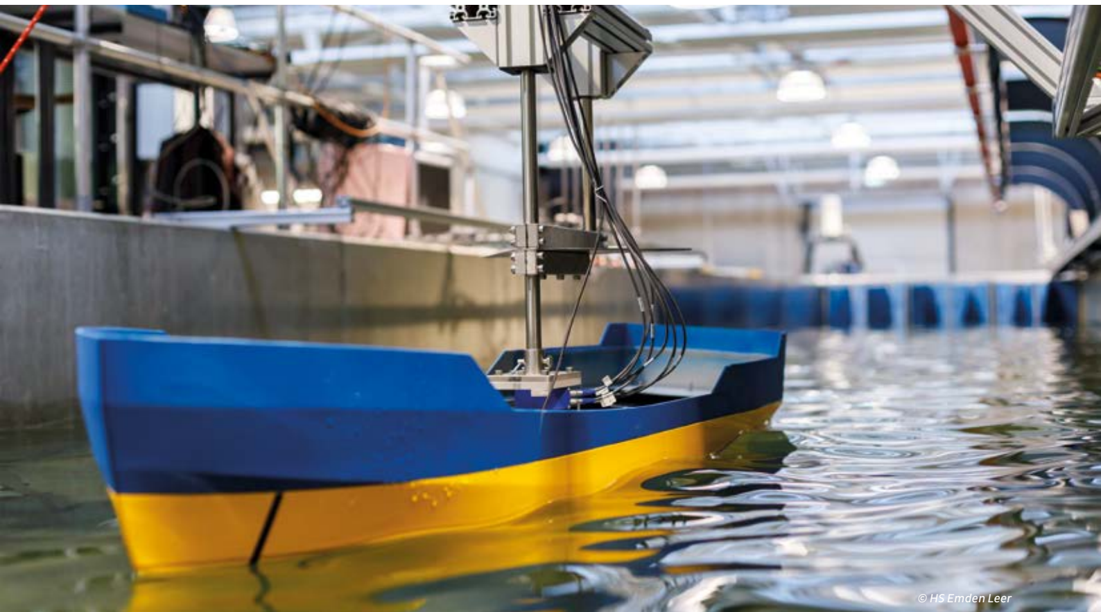
Modellschleppversuch im Manöverbecken
