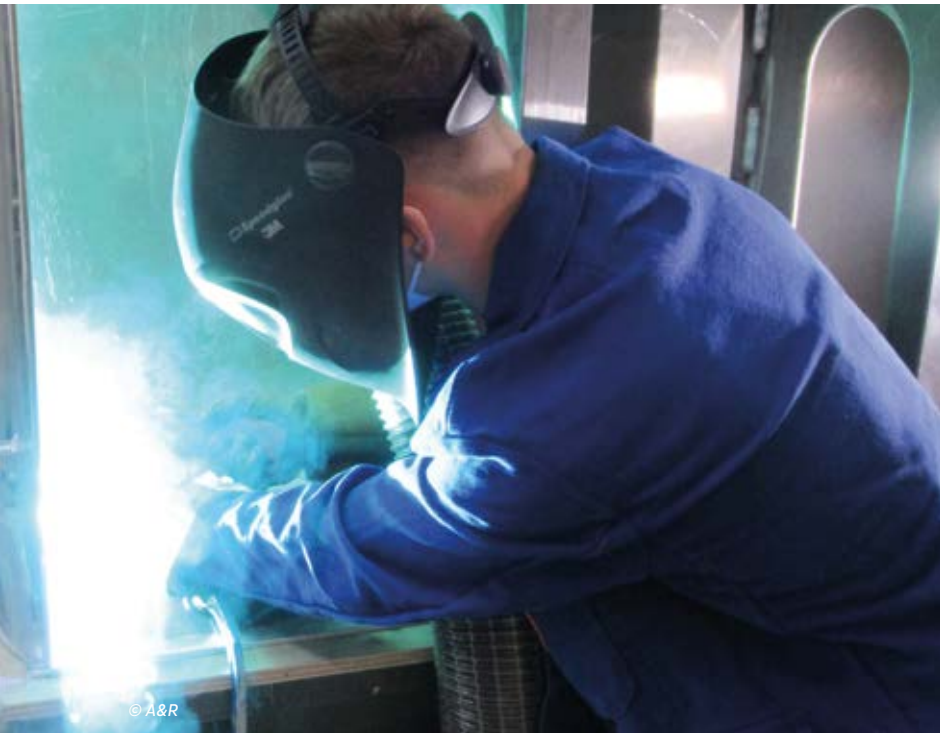
Know-how: In der Ausbildungsabteilung werden Auftriebskörper geschweißt
