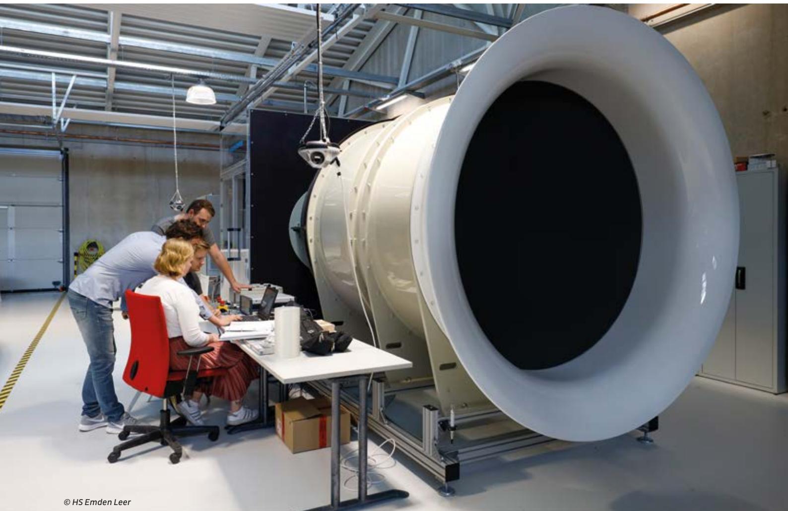
Windkanal für Versuchsreihen zur Strömungsdynamik
