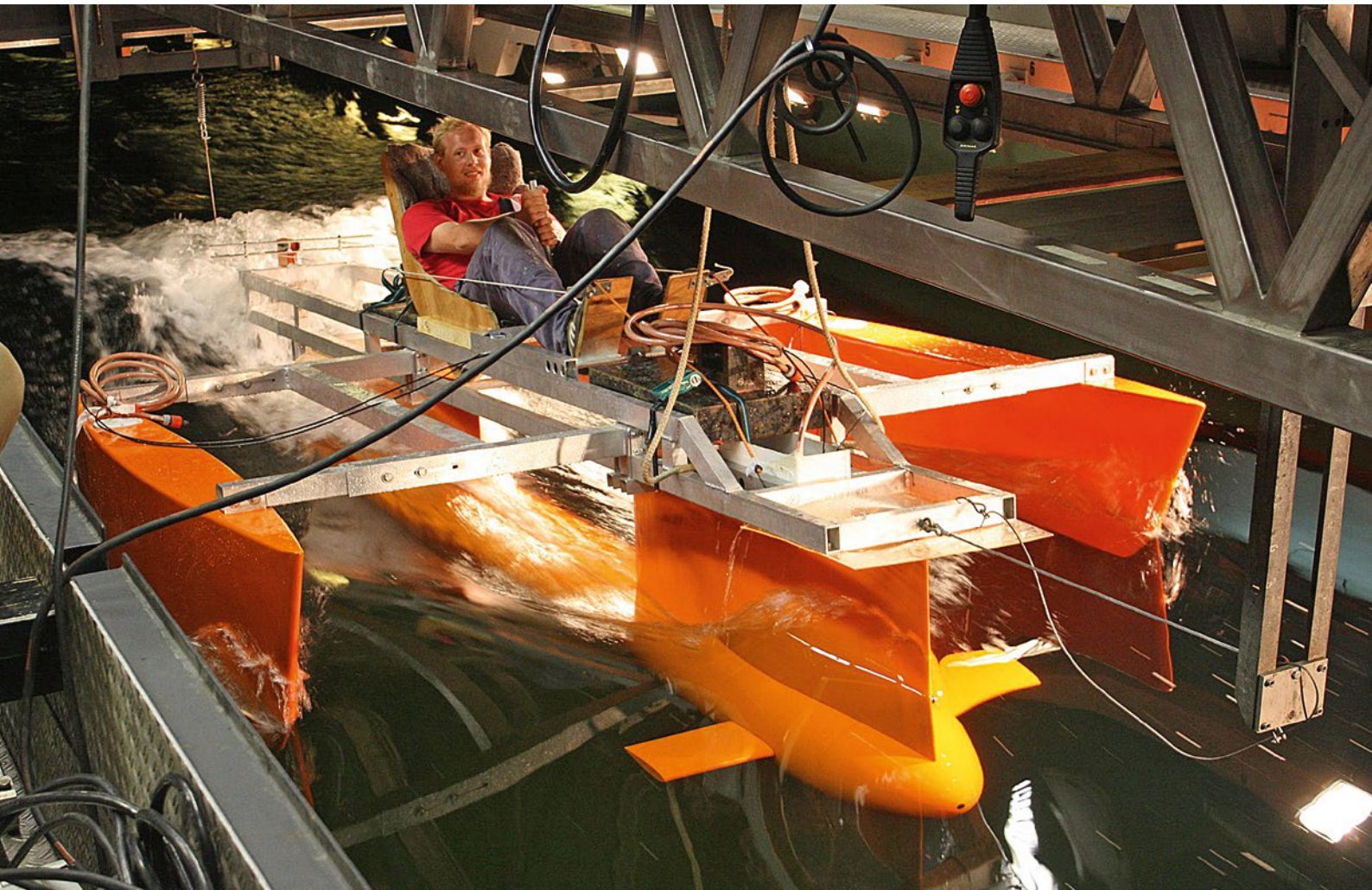
PROJEKTARBEIT. In Kooperation mit der Werft Abeking & Rasmussen haben angehende Schiffbauingenieure der TU Berlin das Rumpfkonzzept SWASH entwickelt. Das Modell wurde in der Tiefwasser-Schlepperrinne der Versuchsanstalt erprobt.
