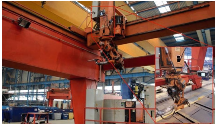
MESSAUFNAHME. Der Scanner wird an der Linearachse des Roboters montiert. Mit ihm lässt sich der Arbeitsbereich aus mehreren Perspektiven erfassen.
