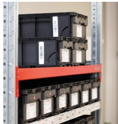
DAS KANBAN-SYSTEM. C-Teile werden just in time direkt am Lagerort zur Verfügung gestellt.
