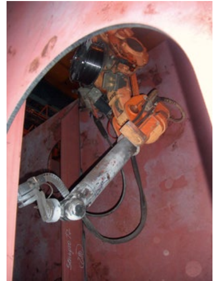
EINSATZ. Die Roboter können auch in sehr hohen und engen Boxen kollisionsfrei arbeiten.
