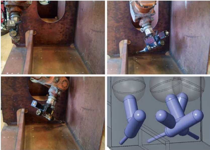
RISIKOMINIMIERUNG. Die Kollisionsprüfungen werden für verschiedene Nahtpositionen durchgeführt.
