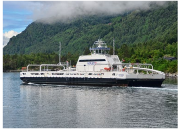
ELEKTROANTRIEB. Die „Ampere“ pendelt im norwegischen Sognefjord und ist mit Siemens-Technologie ausgestattet.
