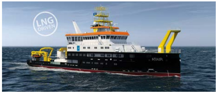
VORREITER. Die „Atair“ ist weltweit das erste seegängige Behördenschiff, das mit einem umweltschonenden LNG-Antrieb ausgerüstet ist.
