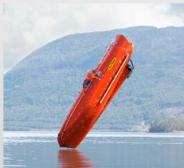
ZUVERLÄSSIG. In den Freifall-Rettungsbooten von Palfinger finden bis zu 70 Personen Platz.
