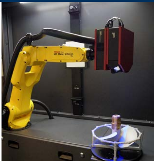
FERTIGUNGSGENAUIGKEIT. Die SVA Potsdam setzt bei der Erstellung von Modellen auf 3-D-Oberflächenscanner.
