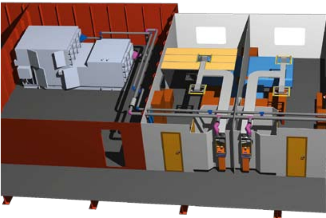
Platzsparer: Die Fan Coil Unit für die Schiffskabinen ist 23 cm flach und schmiegt sich so an die Außenwand der Nasszellen. Dennoch können die leisen Gebläsekonvektoren bis zu 225 m³/h Luft befördern.
