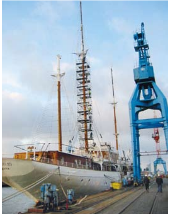
Der Kreuzmast wird eingerüstet; noch steht der Vormast.
