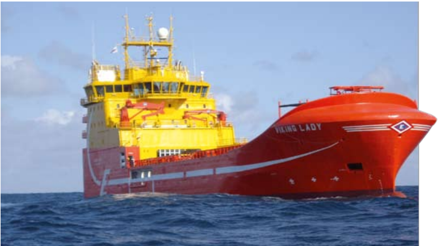
Vorreiter: Auf dem Offshore-Versorgungsschiff VIKING LADY kommt erstmals eine LNG-betriebene Hochtemperatur-Brennstoffzelle an Bord eines Schiffes zum Einsatz.
