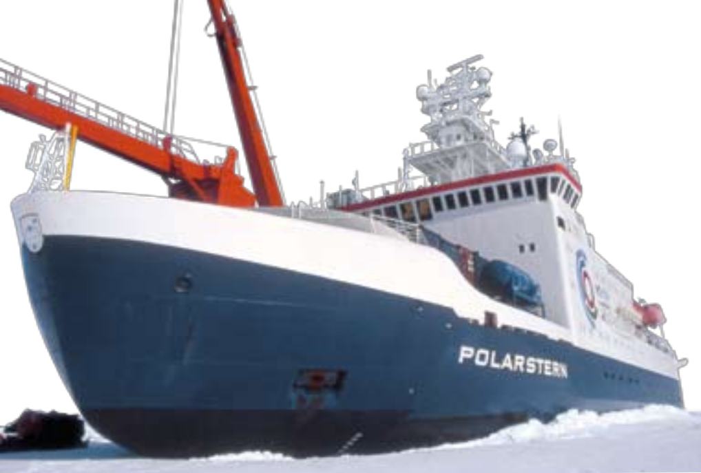
Der deutsche Eisbrecher POLARSTERN nutzt das Fächerecholot HYDROSWEEP und das Sedimentecholot PARASOUND von ATLAS HYDROGRAPHIC unter härtesten Bedingungen (Foto: H.Grobe, Quelle: Alfred-Wegener-Institut)
