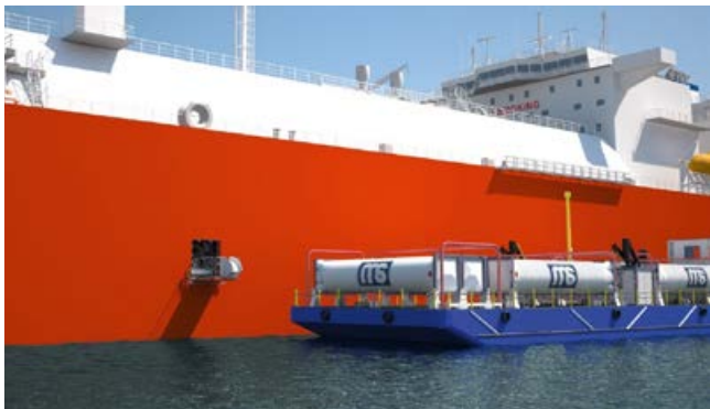
BUNKERPFORTE. Die Barge wird längsseits an einem LNG-Tanker positioniert und kann dort direkt das Flüssiggas aufnehmen.
