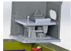
MESSUNG. Ein ausgeklügeltes Wägezellensystem ermittelt exakt die LNG-Masse bei Befüllung und Entleerung der Container.
