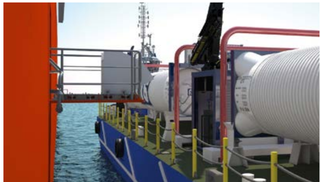
TANKS. Bis zu zwölf Container auf dem Ponton können gleichzeitig über ein Rohrleitungssystem mit flüssigem Erdgas betankt werden.
