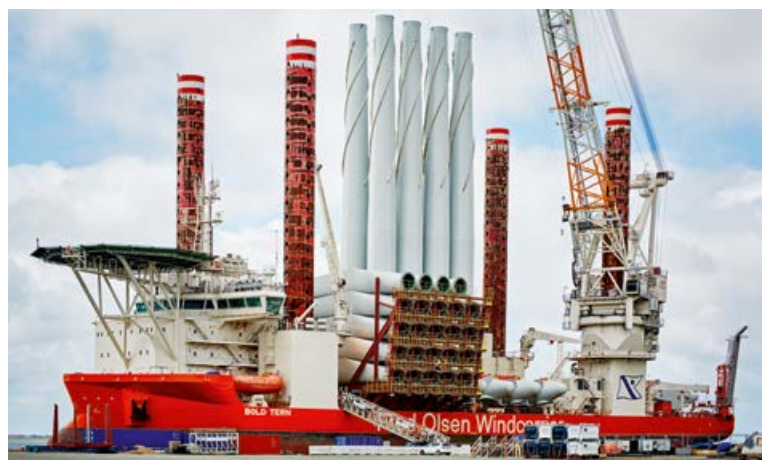
VERSCHIEDENE EINSATZGEBIETE. Installationsschiff für die Errichtung von Windparks.
