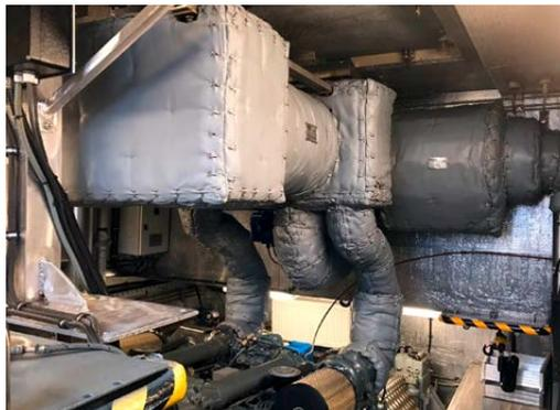
fähigkeit, wurden im Laufe des Jahres vier weitere Schiffe der Flotte Hamburg mit den kombinierten Abgasreinigungssystemen von TEHAG ausgerüstet. Seit Anfang November laufen die Umbauarbeiten auf dem Polizeiboot „WS 31“, bis Ende des Jahres werden insgesamt sechs Schiffe nahezu ohne Ausstoß von Luftschadstoffen fahren.
