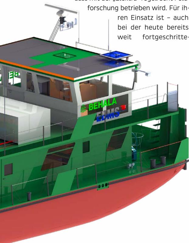
nen Akkumulatorentechnik respektive -kapazität – ein ausgeklügeltes Netz an Ladestationen notwendig. Dies ermöglicht dem Projektboot und seinen Nachfolgern, ihre Akkus innerhalb von sieben bis acht Stunden, so die Vorgabezeit, wieder aufzufüllen. Ein Energiemanagementsystem wird dafür sorgen, dass die begrenzte Energie an Bord optimal genutzt wird. So ist die Konkurrenzfähigkeit gegenüber konventionell angetriebenen Schiffen gegeben, hoffen die Initiatoren.
