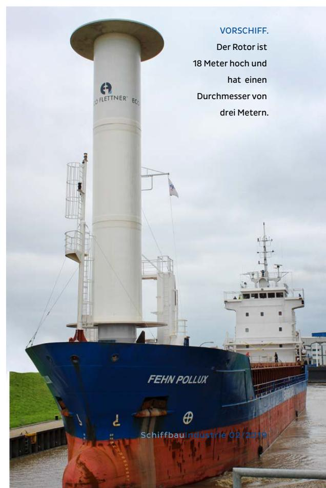
**VORSCHIFF.** Der Rotor ist 18 Meter hoch und hat einen Durchmesser von drei Metern.
