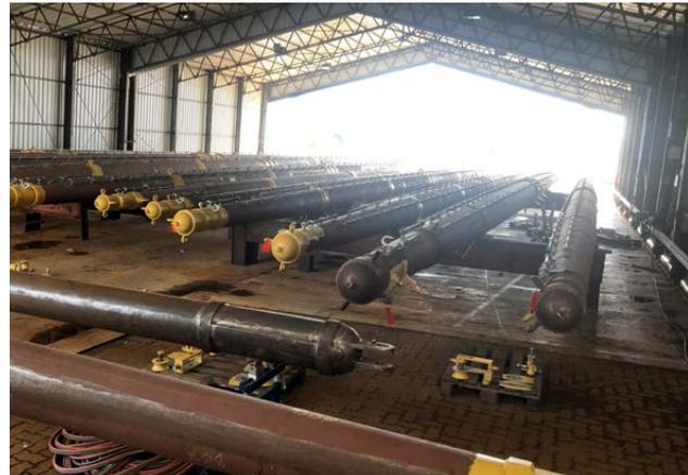
**REKONSTRUKTION.** 16 Rahen mussten für die „Peking“ möglichst originalgetreu nachgebaut werden.
