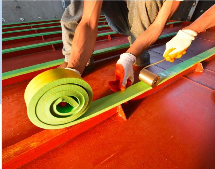
**KOMFORTPLUS.** Lärm- und vibrationsempfindliche Bereiche wie Kabinen werden mit Sylomer®-Streifen ausgekleidet und von der Umgebung entkoppelt.
