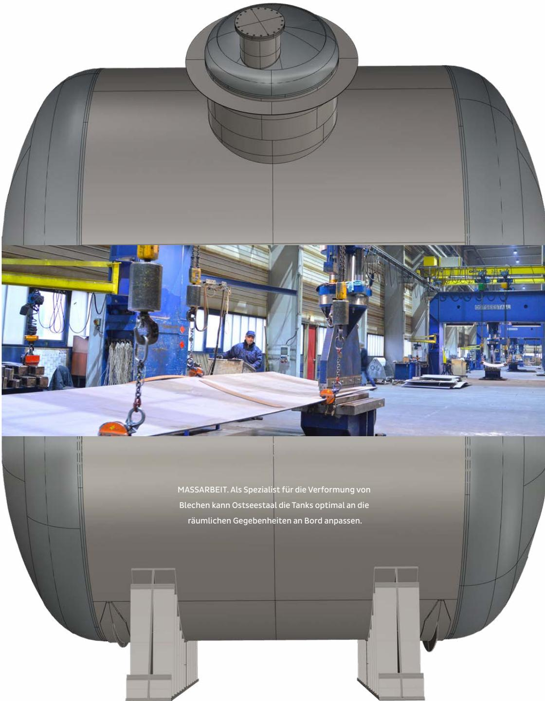
MASSARBEIT. Als Spezialist für die Verformung von Blechen kann Ostseestaal die Tanks optimal an die räumlichen Gegebenheiten an Bord anpassen.
