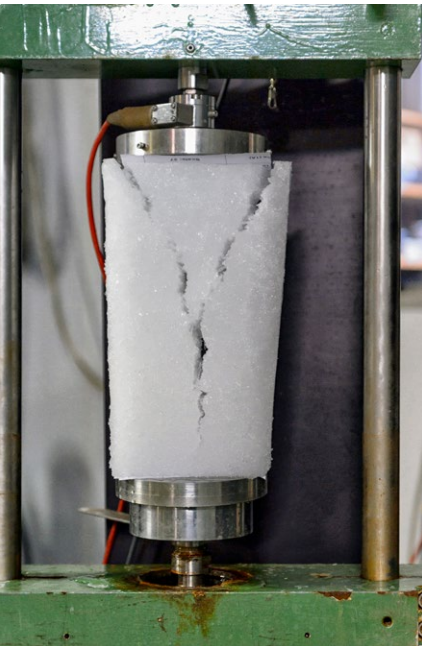
EISLABOR. Die einheitliche Güte der Eisschicht wird regelmäßig mit einem Drucktest überprüft.
