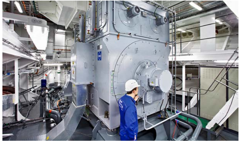
PRODUKT. Einer der beiden 11-MW-Propellerantriebe für die von der FSG im Auftrag der kanadischen Reederei BC-Ferries gebaute Fähre.
