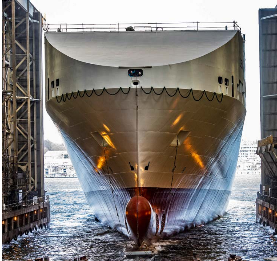
STAPELLAUF. Der aktuelle FSG-Neubau für Siem wurde auf den Namen „Leevsten“ (plattdeutsch für „Liebste“/„Liebsten“) getauft. Die RoRo-Fähre ist knapp 210 Meter lang und 26 Meter breit.
