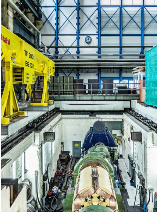
KNOW-HOW. Prüfung eines Schenkelpolläufers für einen Synchronmotor im Bereich 14 MW – 10 kV – 6 - polig.
