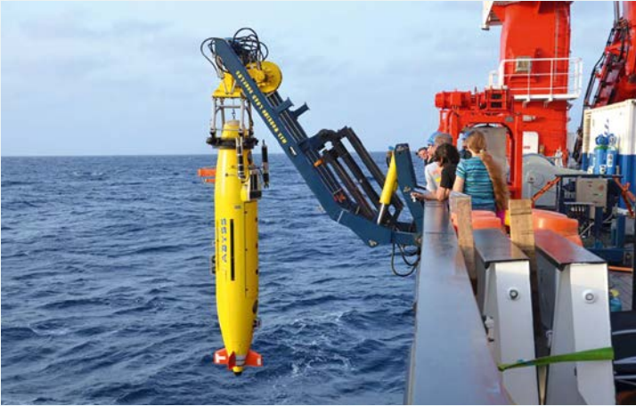
TIEFSEEFORSCHER. Das autonome Unterwasserfahrzeug (AUV) „ABYSS“ kam während der Expedition zum Einsatz, um den Meeresgrund exakt zu kartieren.
