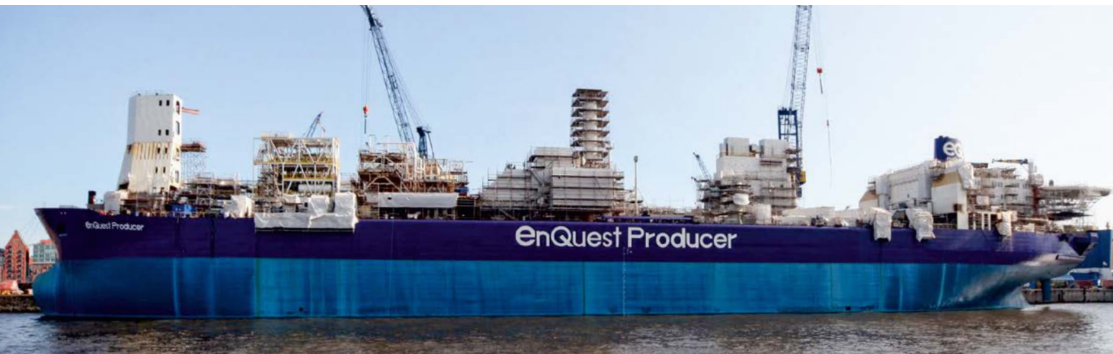
UMBAUARBEITEN. Der 248 Meter lange ehemalige Tanker wurde bei Blohm + Voss Repair in Hamburg umfassend saniert.
