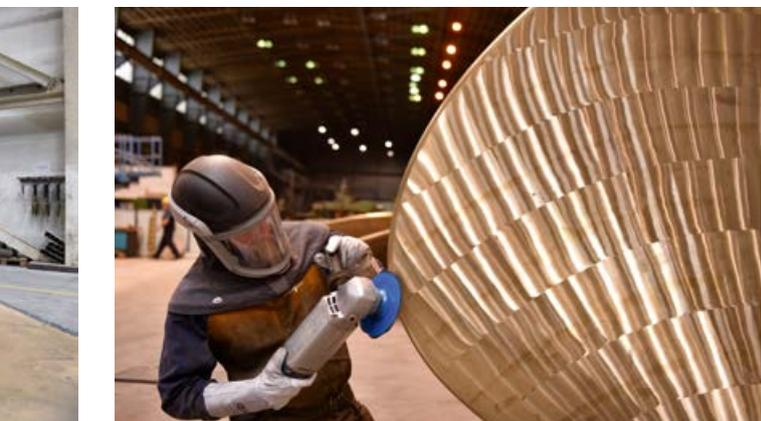
**FEINSCHLIFF.** Mit Augenmaß und Flex bearbeitet der MMG-Mitarbeiter die Oberfläche des Bronzepropellers.
