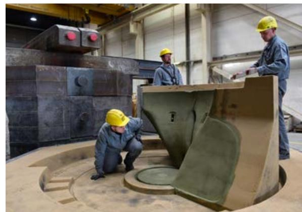
**BAUKUNST.** Die Bronze wird in eine vorgefertigte Zementform gegossen. Sie ist ein Negativabdruck des Propellers.
