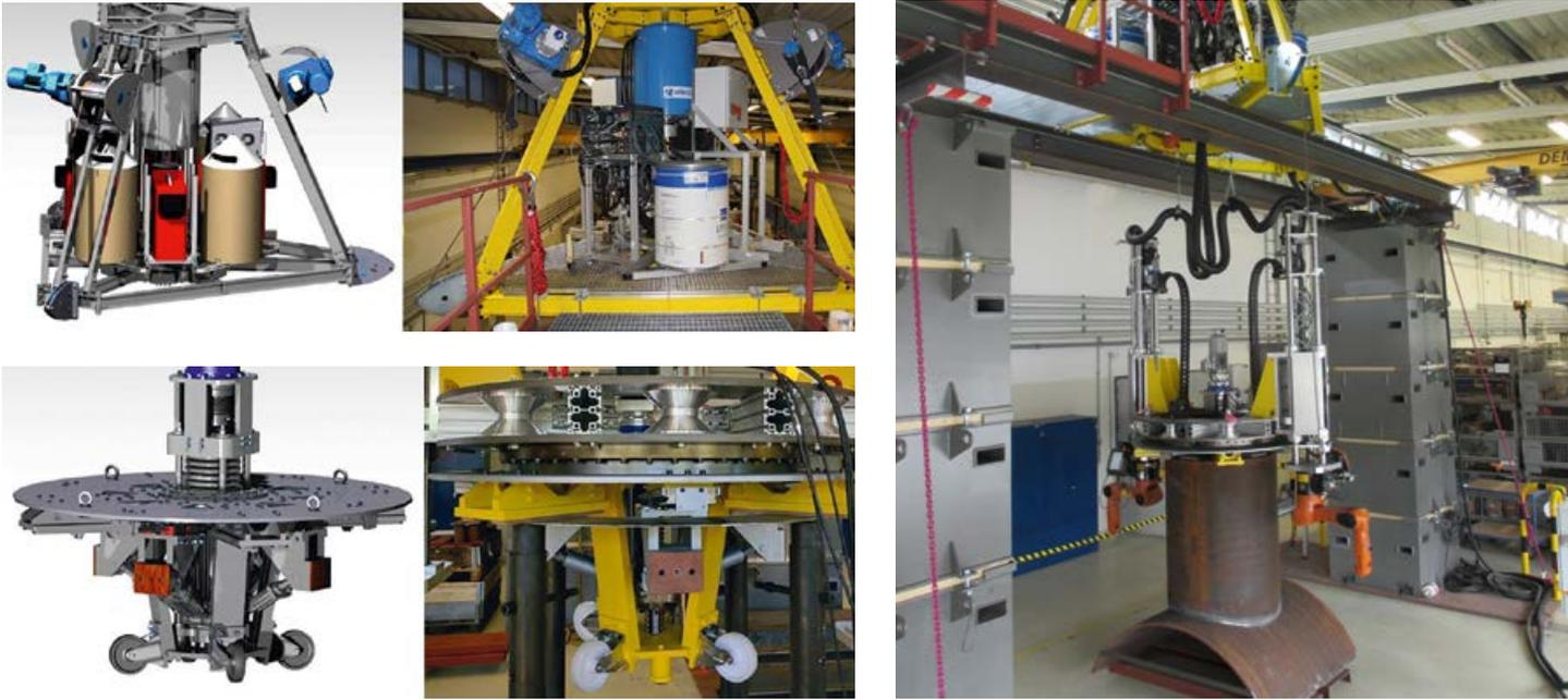
VERGLEICH. Was per CAD entwickelt wurde, funktioniert in der Realität bestens. Versorgungsplattform (o. l.), Klemmmechanismus (u. l.) und Aufbau Gesamtanlage (r.).
