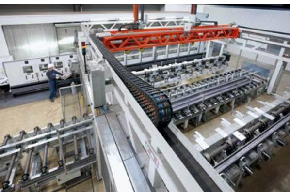
**PRÄZISION.** Durch das SE-|M|®-Verfahren werden geringstmögliche Toleranzen (0,2 mm) in der Hauptfunktionsfläche des Profils erreicht.
