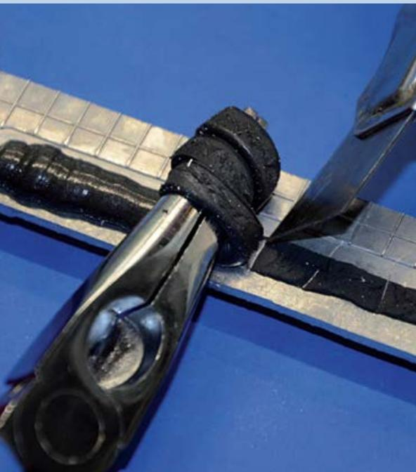
**HÄRTETEST. Manueller Raupenschälversuch zur Prüfung der Haftung eines Klebstoffes.**
